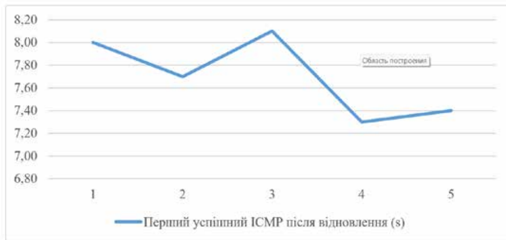
Рис. 3. Графік вимірювання часу відновлення R1
